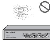
灰尘落在路由器表面会造成静电吸附，使金属接点接触不良。虽然设备本身在防静电方面做了一定措施，但当静电超过一定强度时，仍会对内部电路板上的电子元器件造成致命的破坏，为避免静电影响设备正常工作，请注意以下事项：
